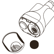
Puhdista suodatinverkko (5) ja suodattimen suojus (6).
