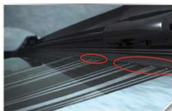
Cracked blade Poröses Wischgummi
